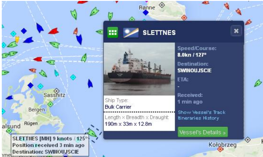
Ryc. 5. Wizualizacja ruchu statków (po wskazaniu kursorem symboliki statku otrzymujemy pakiet informacji dotyczący danej jednostki wraz z aktualnym kursem i portem przynaczenia)
